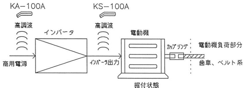
インバータの入力・出力の高調波状態を非接触で測定することにより以下の箇所の診断を行うことができます。
